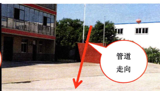
厕所（管道 5 米范围内）及排污池位于管道正上方
