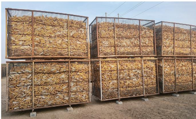
有效散热提升风干速度；通过叉车码到晒粮场，为节约场地，提升仓储量，每排可以码到两个筐高。晒粮过程中可对筐进行二次翻倒通风，促进水分蒸发，加快晾晒进度。玉米水分达标后，用叉车将筐移送到翻转机的翻转座上，通过玉米筐的特殊构造自动与翻转机座锁制，翻转机架体两侧设置有液压油缸，液压油缸的液压杆与翻转座相连，通过液压油缸可驱动翻转座翻转，进而带动玉米筐翻转，对玉米筐内的玉米进行翻倒，卸完玉米后再用叉车将空框移走，操作简单。
