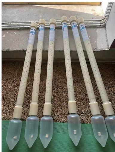
实时在线监测、计数准确、预测分析等亮点。整仓的监测结果与预测准确率达 90% 以上，并且可预测未来一周害虫的发生趋势。该系统可以提高储粮害虫预警能力、节省人工、降低成本，每年可减少 1-2 次的磷化氢熏蒸，可产生约 30-50 万元经济效益。同时，由于减少了杀虫剂使用带来的环境污染与资源浪费，从源头上提高粮油品质和安全保障水平，实现从“被动应对”向“主动保障”的转变。
